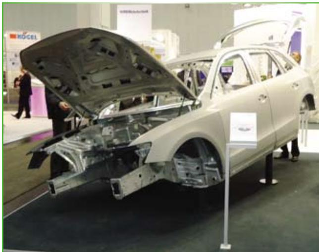
Carroceria contendo exemplos de aplicação dos aços de alta resistência da siderúrgica alemã Salzgitter
