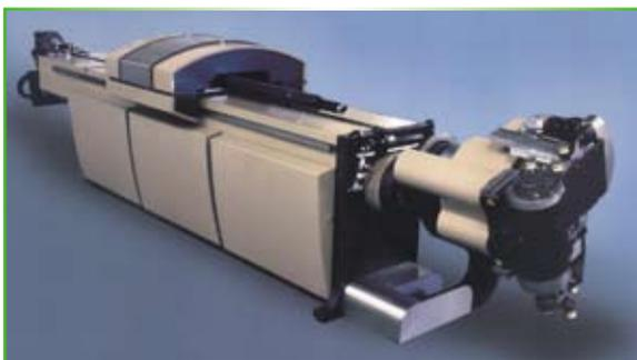
Máquina servoacionada Elite, da holandesa Dynobend, cujo cabeçote permite a execução de duas modalidades diferentes de curvamento
