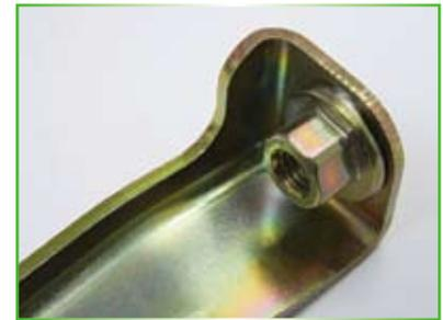
*Peça estampada com uma porca inserida por soldagem por descarga capacitiva. A peça foi mostrada pela Schuler como exemplo da integração de operações complementares ao processo de estampagem, possível mediante o ajuste dos movimentos e pausas do martelo servoacionado da prensa.*
