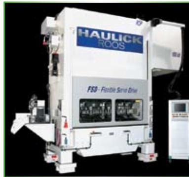
*Prensa fabricada pela alemã Haulick + Roos, equipada com seu sistema de servoacionamento FSD*
