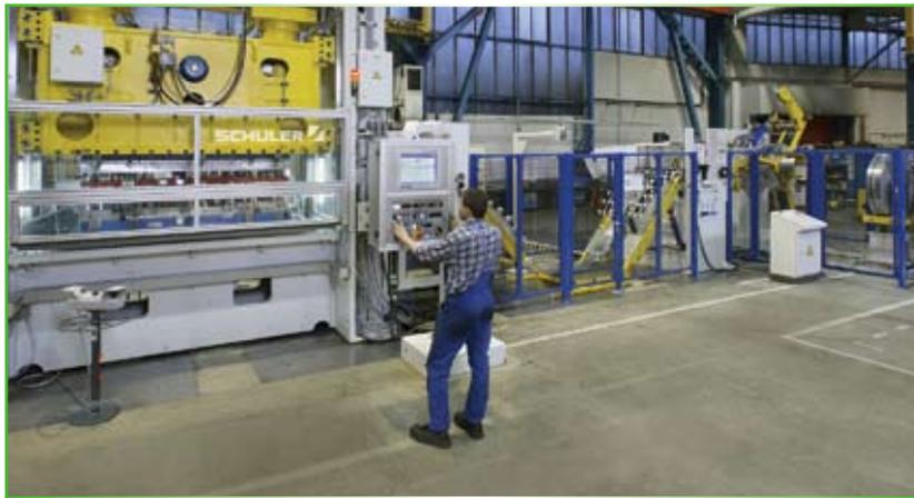
*A liberdade de controle dos movimentos do martelo permite que os ciclos de trabalho da prensa sejam sincronizados com exatidão às operações dos periféricos de automação*
