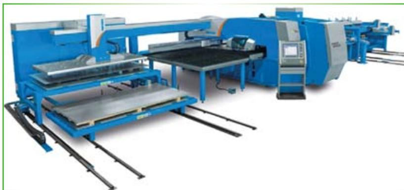
*Puncionadeira servoacionada Shear Genius, da finlandesa Finn-Power, equipada com diversos recursos de automação*
