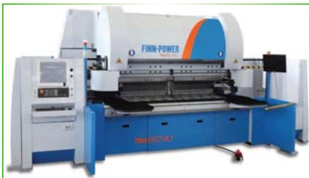
*Centro de dobramento servoelétrico FastBend FBe5-3, da FinnPower*
