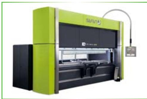
*Prensa dobradeira servoacionada E-Brake 300T, fabricada pela Safan (Holanda)*
