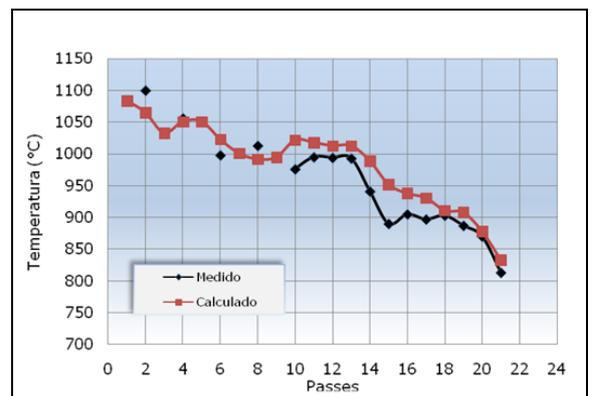
(d) Aço microligado, espessura 22,4 mm.
