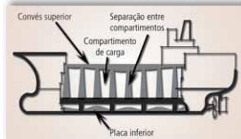
Fig. 10 – Aplicações práticas de chapas grossas com espessura variável na construção naval<sup>(18)</sup>
