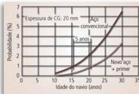
Fig. 8 – Aumento da vida útil das chapas usadas no convés superior de navios-tanque, proporcionado pelo novo aço desenvolvido pela JFE Steel<sup>(18)</sup>
