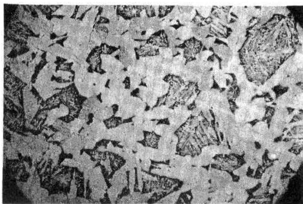
Foto 3: Microestrutura do aço bifásico: matriz ferrítica; ilhas de bainita e martensita isolada. Ataque: Nital 5%. Aumento: 200 x. Ampliação: 4 x.
