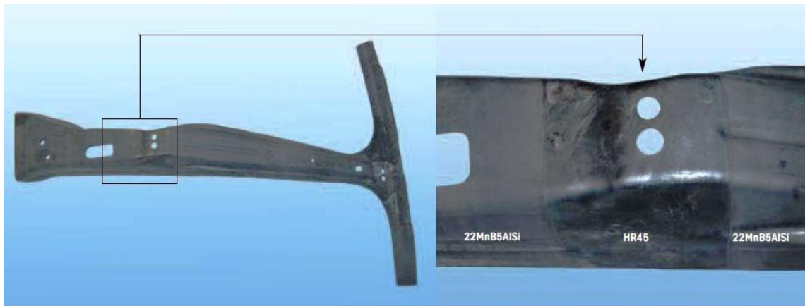
Figura 12 – Coluna B feita com blanques sob medida, incluindo num mesmo componente zonas anti-intrusão e zona para absorção de energia (Nicolas 2006)
