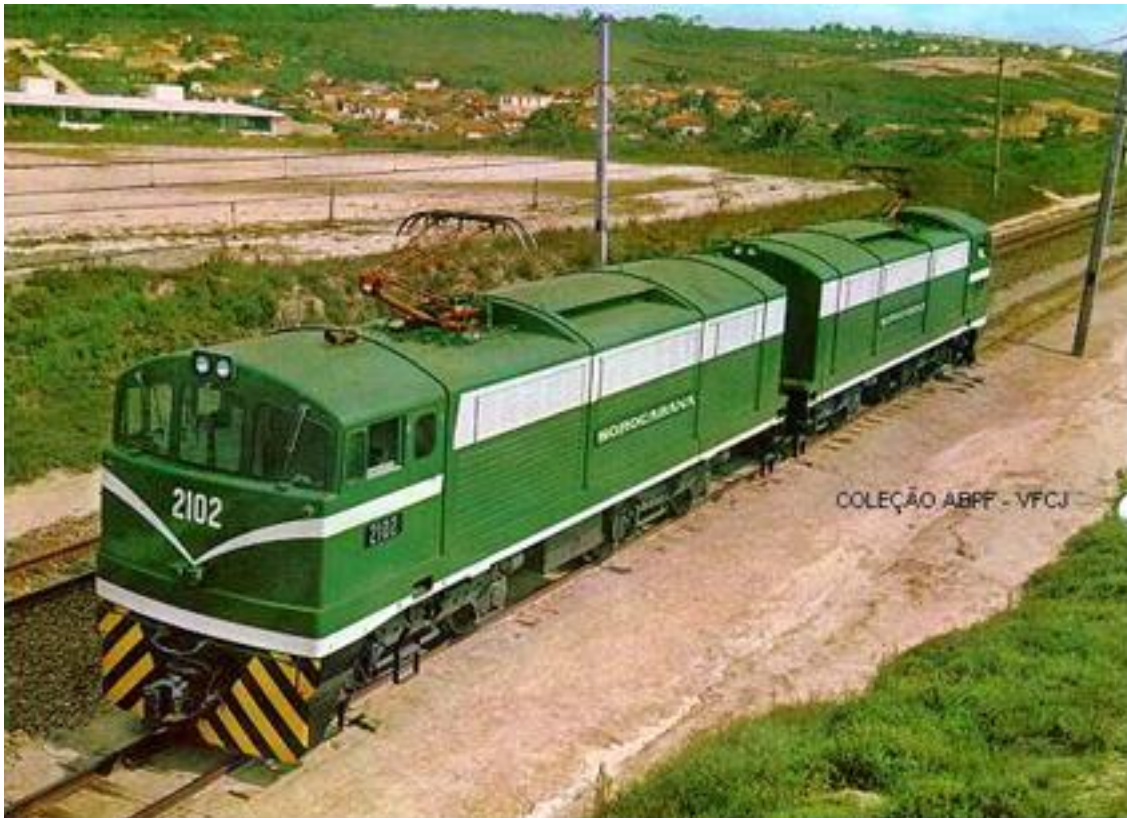
Figura 10.18: Uma visão aérea de duplex de locomotivas elétricas Mini-Saia , fabricadas no Brasil pela General Electric em 1968. Foto disponível no Álbum de Locomotivas da General Electric do Brasil; esta cópia, do acervo da ABPF 181 , é cortesia de Hélio Gazetta.
