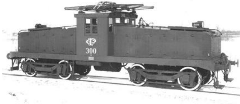
Figura 1.10: Locomotiva elétrica para manobras da Companhia Paulista, que tinha o apelido de baratinha , fabricada pela ALCO-GE em 1924. Esta foto a mostra ainda no pátio do fabricante, nos Estados Unidos, sob rigoroso inverno. A Companhia Paulista foi a única ferrovia brasileira de primeira linha a dispor de locomotivas elétricas exclusivamente manobreadas. Foto proveniente dos arquivos da ALCO Historical Locos , esta cópia é cortesia de Alberto H. del Bianco.
