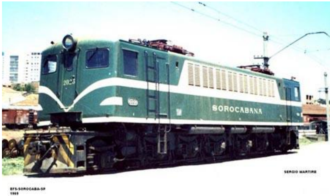
Figura 10.6: Uma foto colorida muito rara de uma locomotiva elétrica Loba (ou série 2000), fabricada em 1948 pela General Electric, estacionada nas oficinas de manutenção de Sorocaba. Original de Sérgio Mártire; esta cópia é cortesia de José David de Castro.
