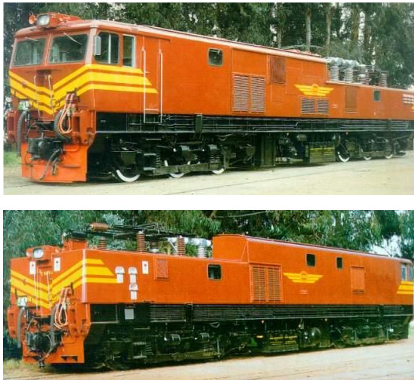
Figura 11.3-A e 11.3-B: Parte frontal e traseira da locomotiva elétrica G.E.C. 9E, de 5070 HP e alimentada com corrente alternada de 50 kV/50 Hz, usada na ferrovia Sishen-Saldanha da South African Railways, especializada em transporte massivo de minério de ferro. Foto do site da empresa sul-africana Union Carriage & Wagon Company (Pty) Ltd. 209 , fabricante dessas locomotivas.
