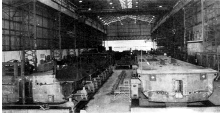
Figura 12.4: Estoque de componentes de locomotivas Alsthom EC-362 na planta de Magé (RJ) da EMAQ Industrial aguardando indefinidamente a fase de montagem. Foto de autoria de Mariza Almeida publicada na edição de abril de 1988 da Revista Ferroviária.
