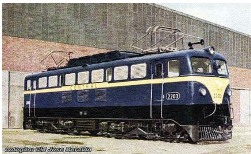
Figura 3.23: Locomotiva elétrica Henschel-Siemens de 3000 HP fornecida para a Central do Brasil em 1958. Esta locomotiva recebeu os apelidos de Pão de Forma e Bondinho . Após o sucateamento da eletrificação das antigas linhas da Central do Brasil, entre Japeri e Barra do Piraí, no final da década de 1970, estas locomotivas foram transferidas para a E.F. Santos a Jundiaí 77 , onde trabalharam até 1987. Um exemplar se encontra apodrecendo em Paranapiacaba. Esta foto, extraída de um anúncio da Siemens, é cortesia de Cid José Beraldo.
