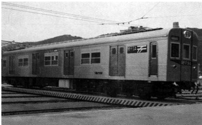
Figura 3.14: Trens unidade elétricos fabricados no Japão pela Hitachi (parte elétrica) e Nippon Sharyo Seizo Kaisha (parte mecânica), como o mostrado na foto, foram entregues em 1977 à Central do Brasil para operarem nos serviços de subúrbios do Rio de Janeiro; eles foram designados como Série 500. A entrada em operação desses trens foi uma das medidas tomadas após a grave crise ocorrida nesse sistema em 1975. Estes foram os primeiros trens suburbanos com caixa de aço inoxidável a operarem no Rio de Janeiro; em São Paulo trens desse tipo circulavam na E.F. Santos a Jundiaí 67 desde 1957. Foto extraída do livro 1937-1987 - Os 50 Anos da Eletrificação dos Trens de Subúrbios do Rio de Janeiro , de
