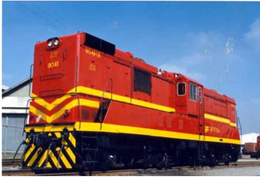
Figura 9.13: Locomotiva elétrica Hitachi com 3.780 HP usada na antiga linha da Serra Velha da E.F. Santos a Jundiaí, transformada em sistema de cremalheira em 1974. Foto originalmente publicada no site da Revista Ferroviária 144 .
