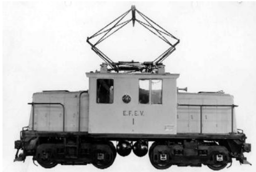
Figura 6.3: Locomotiva elétrica General Electric de 40 t, tipo steepie-cab , fornecida para a E.F. Elétrica Votorantim após a Segunda Guerra Mundial. A legenda desta foto inclui uma data: 24 de Setembro de 1946. Foto oficial da General Electric, tirada com a locomotiva ainda em sua planta em Schenectady, E.U.A.; esta cópia é cortesia de César Sacco.
