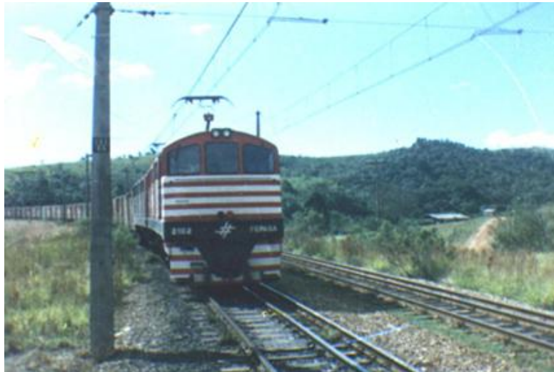
Figura 12.6: Trem de carga tracionado por locomotivas elétricas Mini-Saia , da antiga E.F. Sorocabana 248 , trafegando pelo Corredor de Exportação nas proximidades de Itú. Foto tirada em junho de 1998 por José Henrique Bellório.
