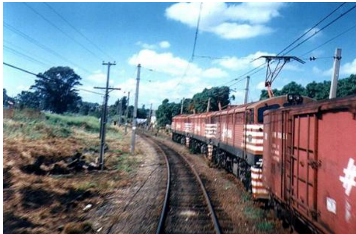
Figura 1.26: Uma rara foto mostrando um trem de carga no trecho Jundiaí-Campinas tracionado por triplex de locomotivas elétricas G.E. Vanderléia . Houve casos em que essas locomotivas foram usadas em duplex. Em todos os casos, contudo, era necessário limitar a potência das locomotivas, já que o sistema de subestações e catenárias não tinha condições de fornecer toda a potência que seria necessária nestas circunstâncias. Foto de José Henrique Bellório.
