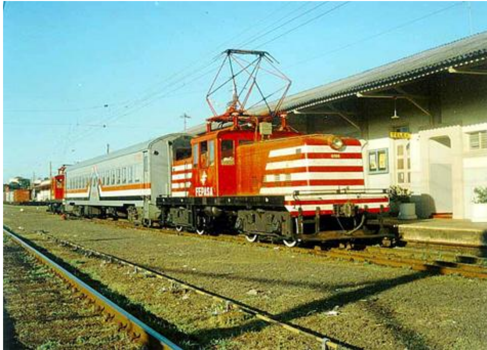
Figura 1.25: Esta foto mostra o Trem Suburbano de Bauru estacionado na estação de Bauru-Paulista. Este serviço de transporte suburbano foi implementado naquela cidade no início da década de 1990. Ele era constituído de um carro de aço carbono tracionado por duas locomotivas manobreadas Baratinha de 600 HP em cada uma de suas extremidades. Infelizmente o serviço não durou muito tempo. Foto do acerto do Museu da Companhia Paulista; cópia fornecida por Paulo Cury.
