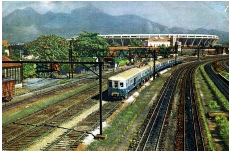
Figura 3.4: Foto do trem unidade elétrica série 100 fornecido pela Metropolitan-Cammell para a E.F. Central do Brasil na primeira fase da eletrificação de seu serviço suburbano. Pode-se observar nesta foto o cenário padrão adotado para essa ferrovia para as fotos oficiais de seu material rodante após 1950: a bela curva panorâmica em frente ao maior estádio de futebol do mundo, o Maracanã . Esta cópia é cortesia de Antonio Carlos Belviso.
