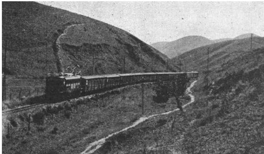
Figura 8.6: Trem de gado da Rede Mineira de Viação, tracionado por uma locomotiva elétrica Siemens-Schuckert, descendo a Serra da Mantiqueira rumo à Barra Mansa nas antigas linhas da E.F. Oeste de Minas. Foto de meados da década de 1940, publicada no anuário Estradas de Ferro do Brasil - 1945 da Revista Ferroviária; esta cópia é cortesia de Kenzo Sasaoka.
