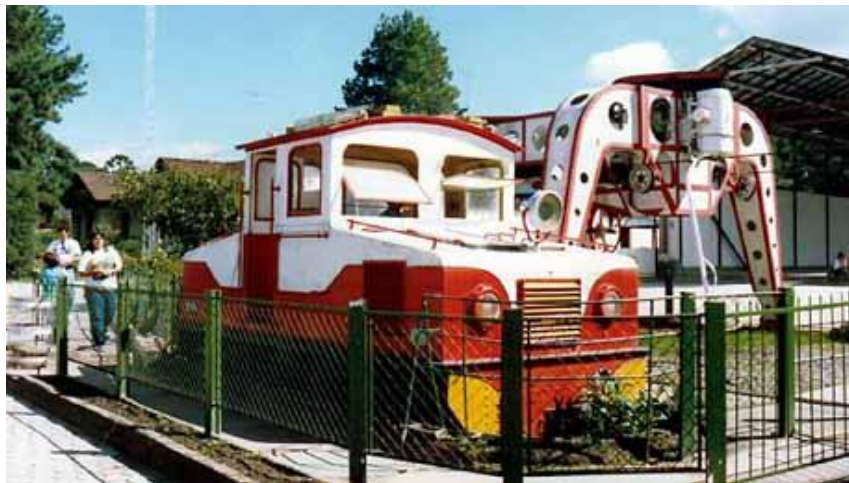
Figura 2.10: A antiga locomotiva elétrica T1 da E.F. Campos do Jordão (Figura 2.9) imobilizada e convertida em motor para o teleférico que liga a estação de Capivari ao alto do Morro do Elefante. Foto de 1990 de autoria de Marcos Ahorn e publicada no boletim virtual Centro-Oeste 43 .
