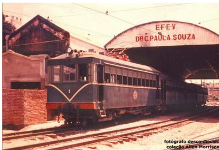
Figura 6.5: Bonde elétrico Brill #1 da E.F. Elétrica Votorantim saindo da estação Paula Souza em 1963. Note as alterações feitas no pantógrafo e na frente plana do bonde durante a grande reforma de 1960; é possível fazer uma comparação com a foto do mesmo carro tirada na década de 1950 (Figura 6.2), que o mostra no estado original... Foto de autor desconhecido; esta cópia é cortesia de Allen Morrison.
