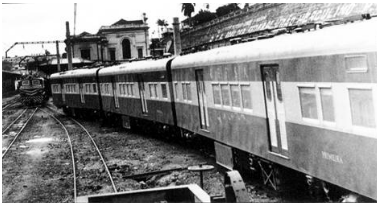
Figura 15.2: Composição de três carros-motor ACF aguardando sua escala na estação de Belo Horizonte para o próximo horário do trem de passageiros entre essa cidade e Divinópolis. À esquerda pode-se observar uma locomotiva Metropolitan-Vickers de 900 HP, já com a pintura da R.F.F.S.A. Foto do Acervo R.F.F.S.A. 272 , reproduzida no livro Ferrovia Centro-Atlântica: Uma Ferrovia e Suas Raízes , de José Emílio Buzelin e João Bosco Setti, editado pela Memória do Trem 273 .
