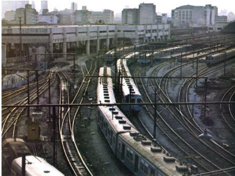
Figura 3.30: TUEs da antiga E.F. Central do Brasil estacionados perto da estação do Brás/Roosevelt em São Paulo. Eles foram fabricados pela Santa Matilde para a primeira fase da eletrificação do serviço suburbano paulistano daquela ferrovia. Esta foto provavelmente foi tirada na segunda metade da década de 1970; é possível ver no seu canto esquerdo inferior um TUE Budd-Mafersa de aço inoxidável sendo rebocado por uma locomotiva diesel-elétrica. Foto originalmente publicada no livro História Ilustrada do Trem , editado pela Fresinbra Industrial S.A. Esta cópia é cortesia de Wilson de Santis.
