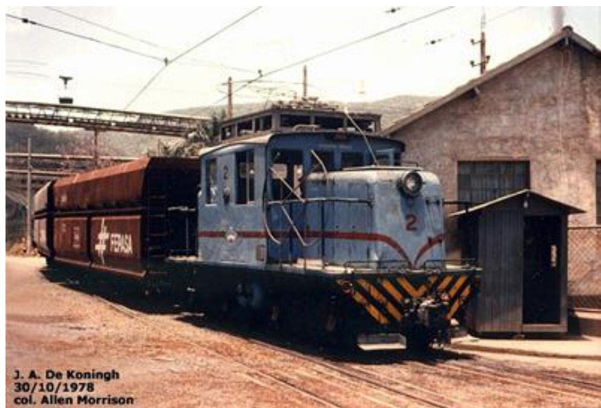
Figura 6.6: Trem da E.F. Elétrica Votorantim nos últimos dias da tração elétrica nessa ferrovia. Note-se que o pantógrafo é bem diferente do usado na locomotiva original (Figura 6.3). Foto de autoria de J.A. de Koningh, tirada em 30 de Outubro de 1978; esta cópia é cortesia de Allen Morrison.
