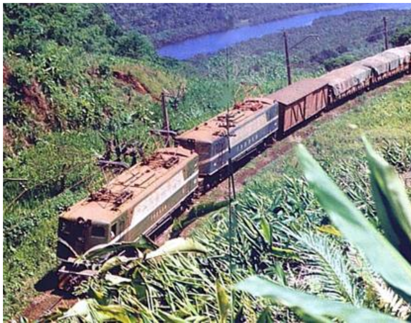
Figura 10.17: Esta foto, bastante rara, atesta o uso de tração elétrica no trecho de Serra do Mar da Mayrink-Santos: ela mostra um trem cargueiro, tracionado por um duplex de locomotivas elétricas Lobas , provavelmente nas imediações da estação Gaspar Ricardo, no pé da Serra. A pintura das locomotivas indica que ela foi tirada entre 1973 e 1976. Foto da coleção de Cid José Beraldo.
