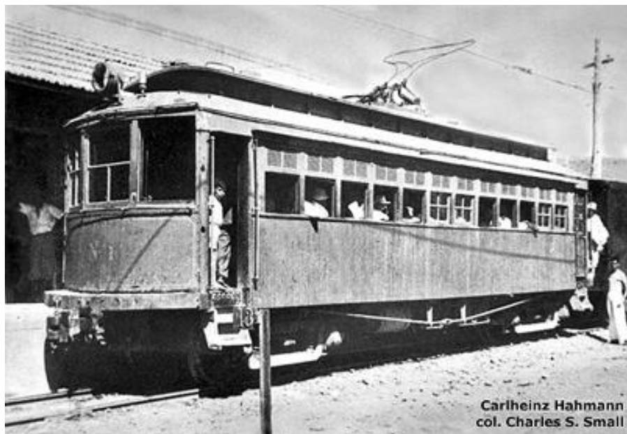
Figura 6.2 Bonde elétrico Brill #1 da E.F. Votorantim. Note o pantógrafo original e a frente arredondada e a compare com a foto do mesmo carro tirada em 1963 (Figura 6.5)... Foto de Carlheinz Hahmann provavelmente tirada na década de 1950, pertencente à coleção de Charles Small; esta cópia é cortesia de Allen Morrison.
