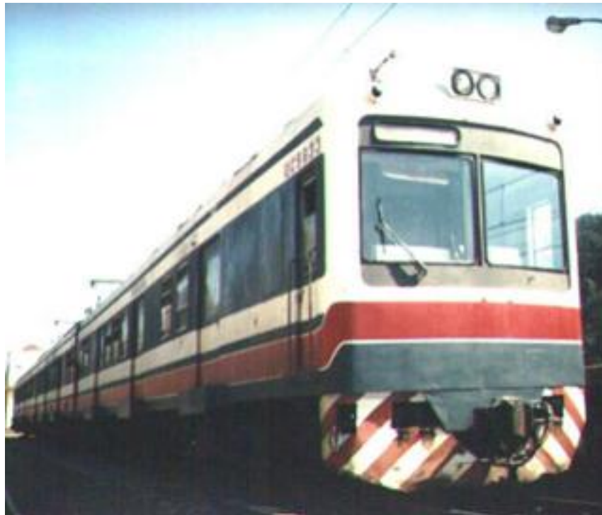
Figura 10.22: Um exemplar do trem unidade elétrico Rio Claro , na verdade unidade fornecida pela Hitachi em 1958 e reformada nas antigas oficinas da Companhia Paulista de Estradas de Ferro 191 em Rio Claro durante a década de 1980. Esse TUE rodava nas linhas de subúrbio da E.F. Sorocabana na Grande São Paulo que permaneceram exclusivamente em bitola métrica. Uma versão especial, tracionada por locomotiva diesel-elétrica ALCO RSD-8 modificada, rodava na linha não-eletrificada entre Santos e Samaritá, na Baixada Santista. Esta foto é cortesia de Alex Elias Ibrahim.
