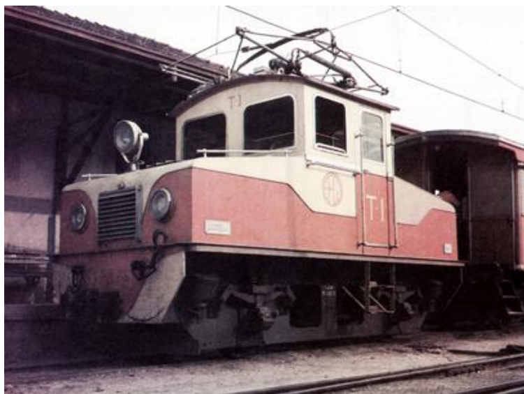
Figura 2.9: Uma rara foto colorida da locomotiva elétrica T1 da E.F. Campos do Jordão em operação. Essa máquina, originalmente fornecida ao Tramway do Guarujá, foi construída em 1924 pela Siemens-Schuckert/M.A.N. (Maschinenfabrik Augsburg-Nuremberg). Ela tinha potência total de 104 HP, proporcionada por dois motores elétricos com auto-resfriamento, peso de 14.600 kg e capacidade de tracionar um trem de 32 toneladas a 40 km/h. Ela foi transferida para a E.F. Campos de Jordão após o desmantelamento do Tramway Guarujá em 1956. Em 1972 ela foi retirada do tráfego ferroviário, sendo imobilizada para acionar o teleférico 40 que liga a estação de Capivari ao alto do Morro do Elefante, que administrado pela ferrovia. Foto de Guido Motta tirada no início da década de 1970 e publicada na edição de Junho de 1989 da Revista Ferroviária.
