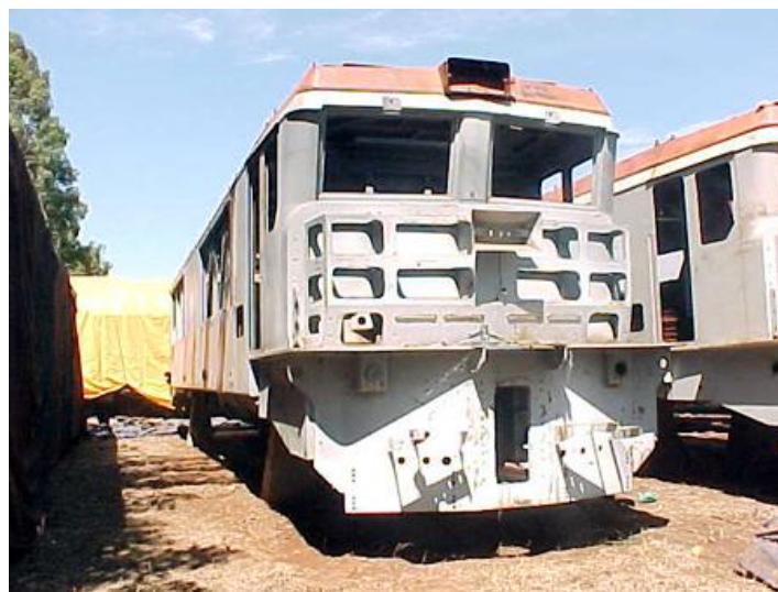
Figura 12.9: Caixas de locomotivas elétricas EC-362 (as Francesas ), de projeto Alsthom, cuja caldeiraria foi interrompida no início da década de 1990. Atualmente elas se encontram abandonadas na planta de Boa Vista (SP) da GEVISA. Foto de autoria de Rodrigo Cunha.
