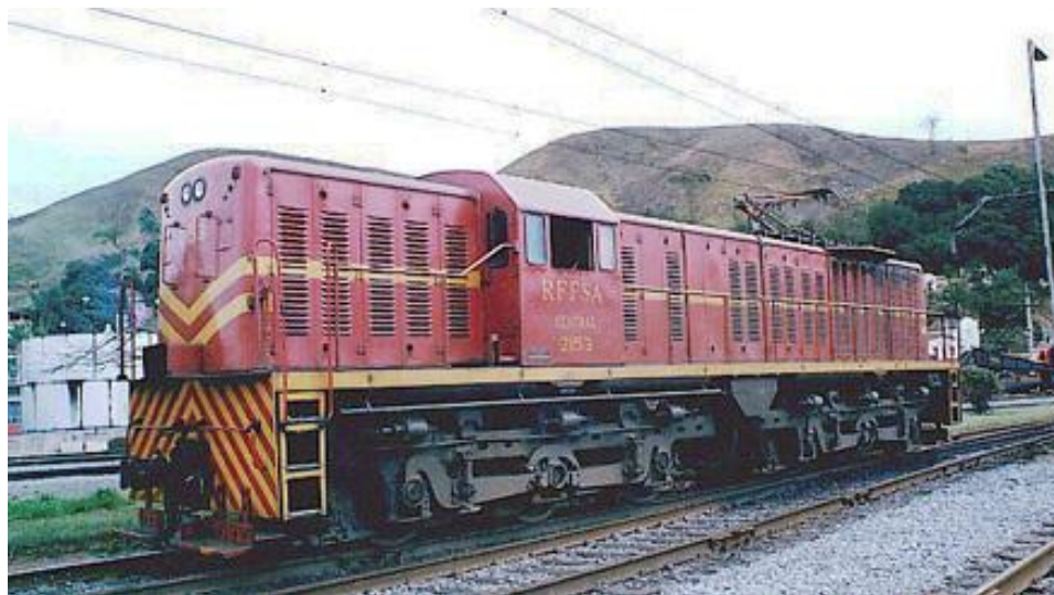
Figura 3.24: Locomotiva elétrica General Electric de 4.000 HP fornecida para a Central do Brasil em 1962 para tracionar trens de carvão para a Companhia Siderúrgica Nacional, em Volta Redonda. Esta locomotiva recebeu originalmente o apelido de Charutão , provavelmente em função de seu formato afilado. Elas trabalharam na Central do Brasil até 1984, quando a eletrificação foi totalmente suprimida de suas linhas de longo percurso. Nesta ocasião elas foram transferidas para a E.F. Santos a Jundiaí 78 , onde trabalharam até a privatização dessa ferrovia. Esta foto, tirada na estação de Barra do Pirai, é cortesia de Cid José Beraldo.
