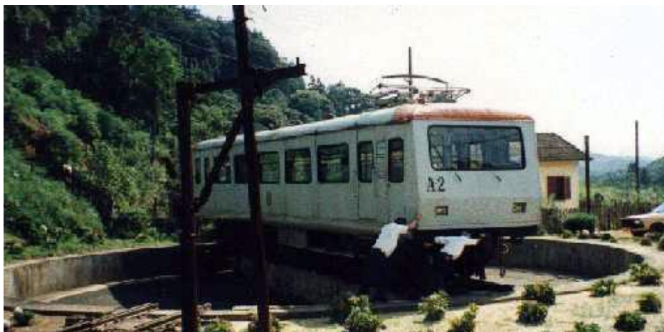
Figura 2.17: As inúmeras reformas efetuadas nas automotrizes da E.F. Campos do Jordão modificaram várias de suas características. Uma das alterações foi a perda de uma das cabines de comando, que deve ter ocorrido para aumentar sua lotação. A foto mostra a automotriz A2 sendo virada em Eugênio Lefreve para retornar à Campos de Jordão durante uma viagem turística. Foto de Antonio Augusto Gorni, tirada em Fevereiro de 1995.
