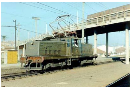
Figura 1.17: Locomotiva elétrica para manobras da Companhia Paulista, apelida de baratona e fabricada pela ALCO-GE em 1947. Esta é a segunda geração desse tipo de locomotivas nessa ferrovia, iniciada com a Baratinha , mas com alguns aperfeiçoamentos, como a carenagem soldada ao invés de rebitada. Foto de Ivanir Barbosa tirada em Jundiaí em 1971; esta cópia é cortesia de Paulo Cury.
