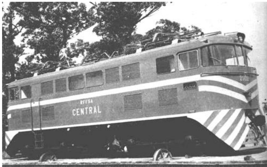
Figura 3.25: Locomotiva elétrica Prado Uchoa de 1072 HP, #2002, originalmente fabricada na Brasil em 1943 (Figura 3.11). Aqui ela é mostrada após reforma feita em meados da década de 1960, quando sua caixa foi alterada, assumindo um padrão mais parecido com a locomotiva elétrica alemã Pão de Forma (Figura 3.23), fornecida para a Central do Brasil pela Henschel-Siemens. Foto publicada numa edição da Revista Ferroviária 80 ; esta cópia é cortesia de Carlos Alberto Rollo.
