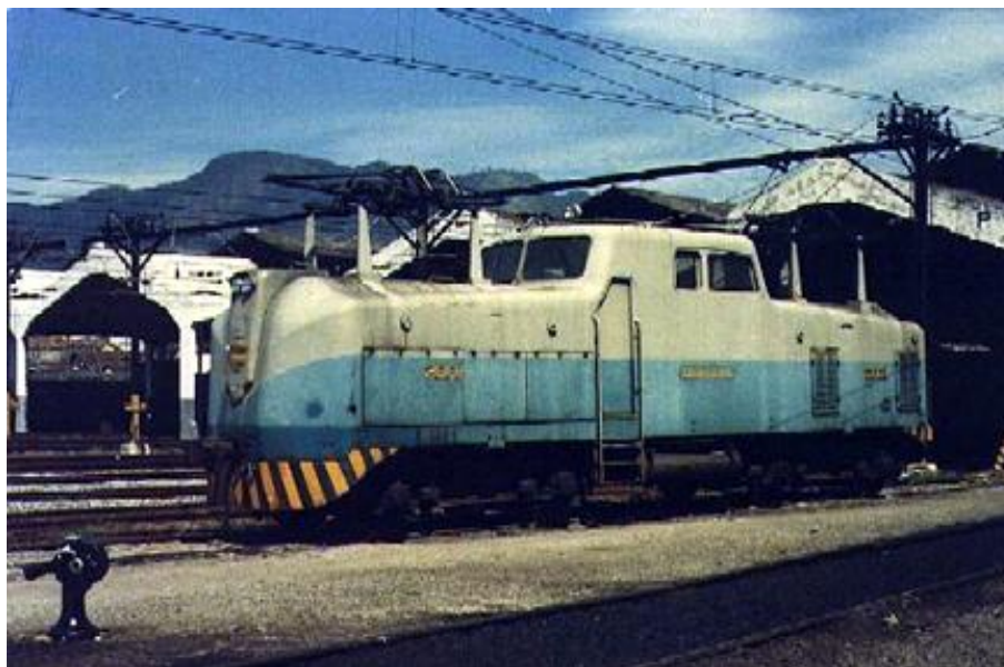
Figura 3.10: Locomotiva elétrica Ferro de Engomar , # 2001, construída em 1939 nas oficinas da E.F. Central do Brasil usando peças sobressalentes dos trens unidade elétricos Metropolitan-Camell. Seu apelido decorreu de seu formato peculiar, aparentemente inspirado nas locomotivas GG1 da Pennsylvania Railroad . Foto original de Marcelo Lordeiro; esta cópia é cortesia de Alberto H. del Bianco.
