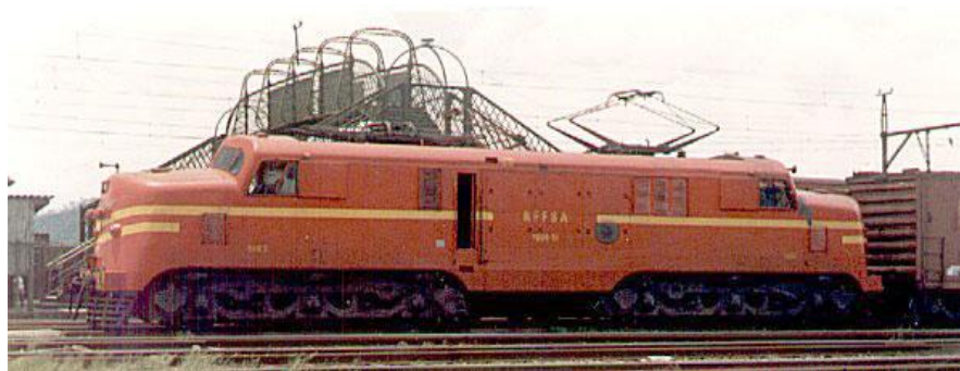
Figura 9.6: Locomotiva elétrica Pimentinha , fabricada pela English Electric no final da década de 1940, tracionando um trem de carga na estação de Campo Grande. Foto tirada por Carlos Roberto Brandão no início dos anos noventa.
