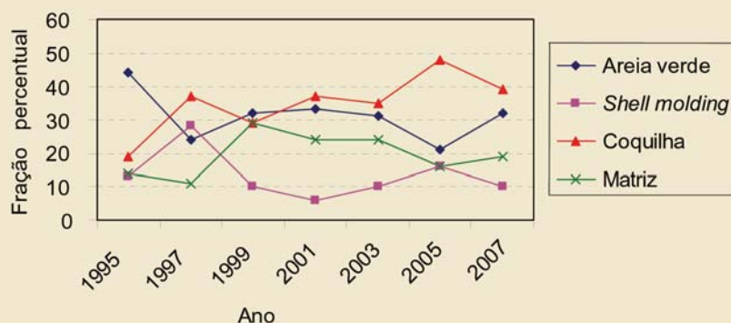
Fig. 12 - Distribuição percentual do número de unidades dos diversos tipos de máquinas para moldagem usados nas fundições pesquisadas. Dados obtidos nos inventários efetuados por FS ao longo dos últimos 12 anos.
