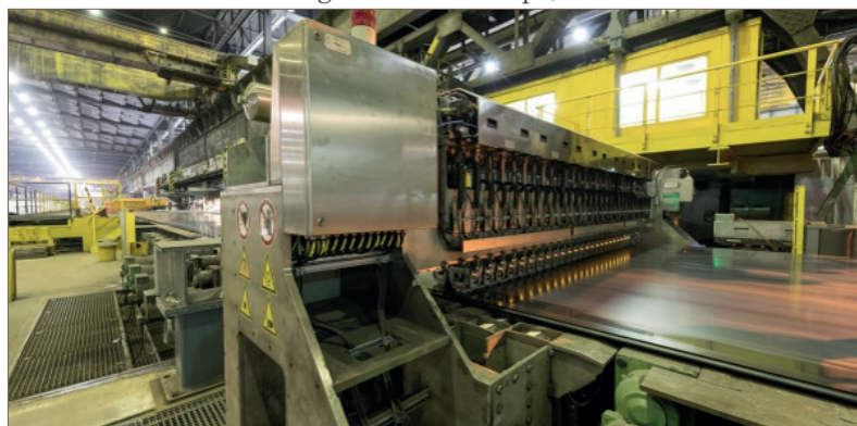
Sistema para inspeção on-line de hard spot em chapas grossas instalado na Dillinger Stahlwerke, Alemanha
