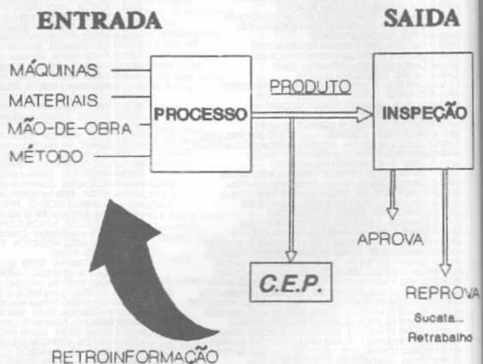
Figura 1: Esquema que ilustra como o C.E.P. se insere dentro de um processo produtivo.
