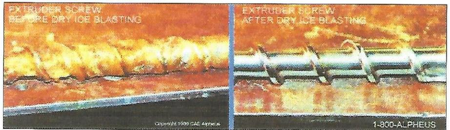
Resultados da limpeza de uma rosca de extrusora contendo restos de resina usando-se jato de ar comprimido com gelo seco. Cortesia da CAE Alpheus Inc. À esquerda, rosca da extrusora antes do jateamento com gelo seco; à direita, a mesma rosca depois do jateamento
