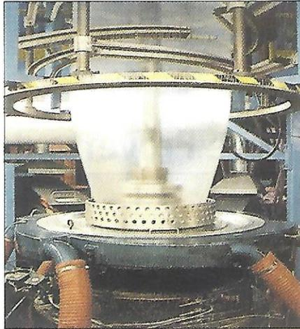
Matriz de co-extrusão aerodinâmica da Brampton Engineering, que permite a produção de filmes balão com até sete camadas de resina
