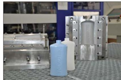
*Fig. 18 – Sistema de prototipagem rápida da Kautex produz pequenas séries de frascos soprados no prazo de 48 horas a partir da finalização do projeto em CAD*
