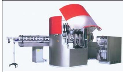
Fig. 17 – A Sacmi adaptou o processo de moldagem por compressão de tampas e pré-formas para o sopro de frascos
