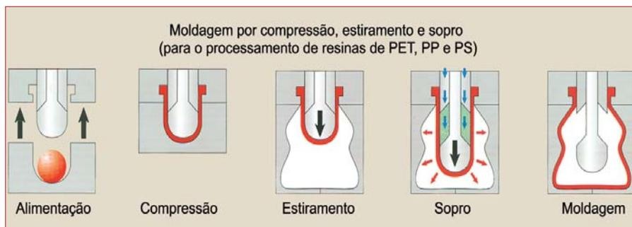
Fig. 16 – Esquema de produção dos frascos por compressão, estiramento e sopro em equipamento da Sacmi
