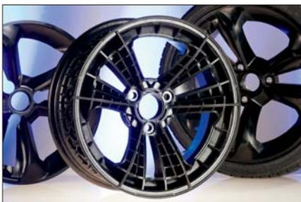
Fig. 6 – Roda automotiva de plástico desenvolvida pela BASF para o carro conceito Smart Forvision
