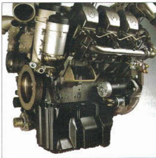
Fig. 10 – Cárter do motor do caminhão Mercedes Actros feito de poliamida reforçada com fibra de vidro fornecida pela Basf. Trata-se da primeira peça deste porte feita com resina termoplástica
