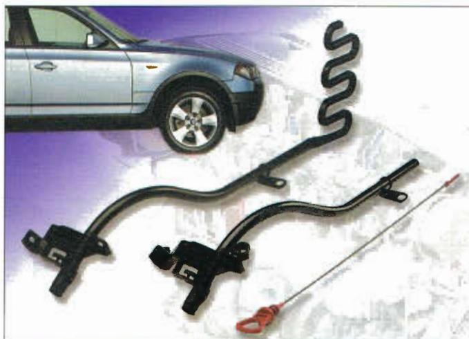
Fig. 2 – Tubo-guia para alojamento da vareta para medição do nível de óleo lubrificante no cárter de motores a diesel da BMW moldado por injeção auxiliada por água com a resina Zytel, fabricada pela DuPont
