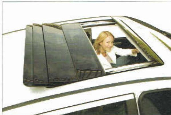
Fig. 15 - Teto solar do automóvel Classe A da DaimlerChrysler feito de Makrolon, resina de PC fabricada pela Bayer Materials Science
