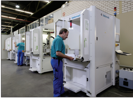
Soldagem a laser em equipamento da Bielomatik: atendimento a requisitos de sala limpa
