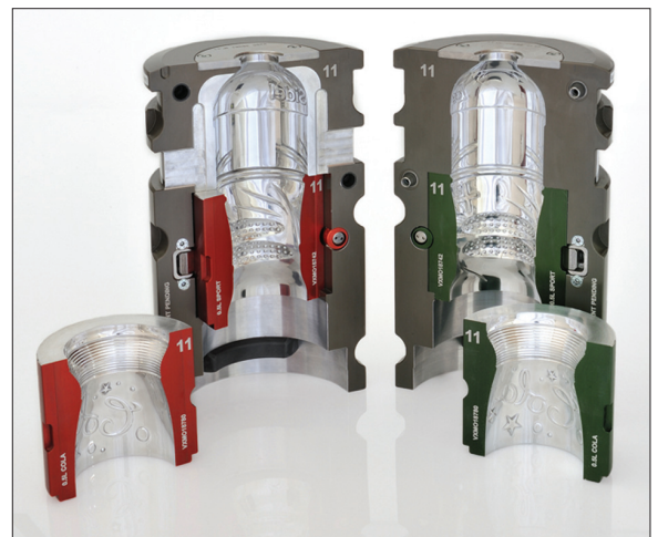
Sistema de troca rápida da Sidel torna possível a mudança de formato das garrafas em alguns minutos
