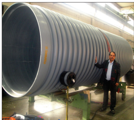
Tubo de plástico com grande diâmetro obtido por extrusão e corrugação
