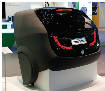
Porta traseira completa híbrida para veículos do tipo hatch, incluindo janela de policarbonato e iluminação de fundo, desenvolvida pela Bayer MaterialScience
