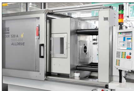
Revestimento em aço inoxidável e câmara para filtragem do ar constituem a “sala limpa” do modelo da Arburg destinado à moldagem de peças para a área médica
