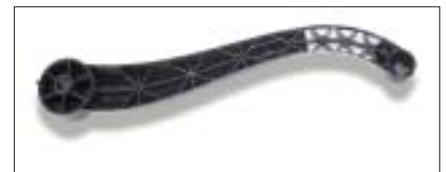
*Reforço para coluna B de automóveis feito por conformação de chapa orgânica reforçada com fibras contínuas mais sobremoldagem de nervuras e outros detalhes usando poliamida. Esta peça composta pesa 200 gramas e possui comprimento superior a 500 mm*
