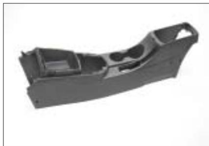
*Console central para modelo de automóvel da Hyundai, feito em composto de PP com carga de esferas de vidro da 3M, moldado pelo processo MuCell, da Trexel*
