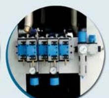
• Bloco de válvulas pneumáticas.
