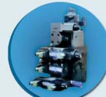
• Bloco de válvulas hidráulicas.
