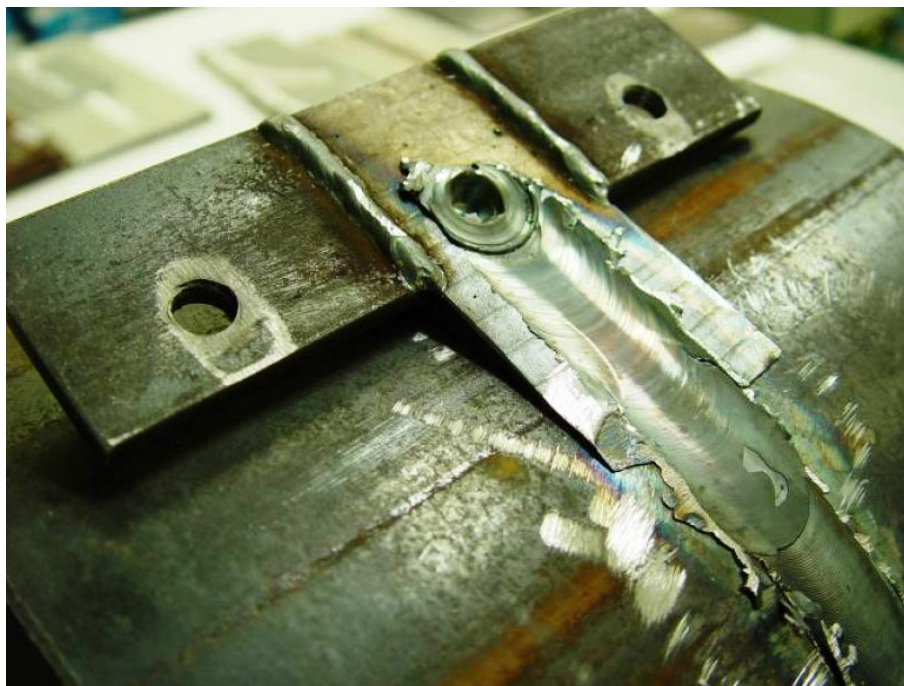
Figura 3: Lingüeta para escape posicionada no final da soldagem circunferencial de tubo [Feng 2005].
