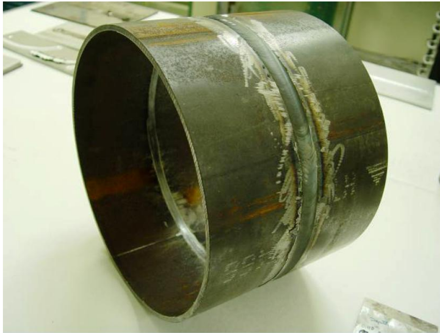
Figura 7: Aspecto final do cordão de soldagem circunferencial feito através do processo de fricção linear em tubo grau API X65 [Feng 2005].
