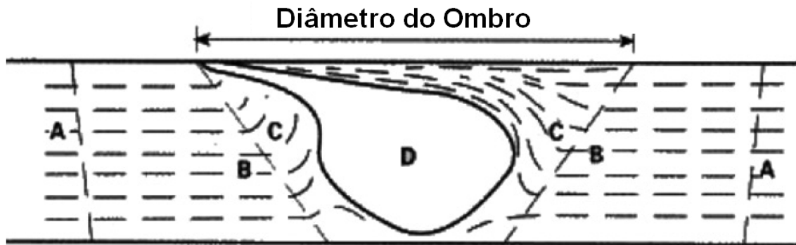
Figura 5: Esquema da seção transversal de uma típica união produzida pela soldagem por fricção linear, mostrando suas quatro zonas típicas: (a) metal-base; (b) zona afetada termicamente; (c) zona afetada termomecanicamente; (d) zona de agitação (botão de soldagem) [Nandan 2008].
