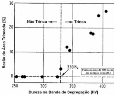
Figura 7: Relação entre dureza na banda de segregação central da chapa grossa e o trincamento decorrente da fragilização induzida por hidrogênio
