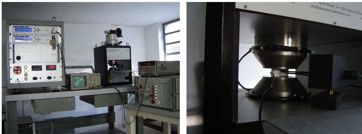
Figuras 1 e 2: Histeresígrafo e detalhe das peças polares com amostra e transdutor de campo magnético.
