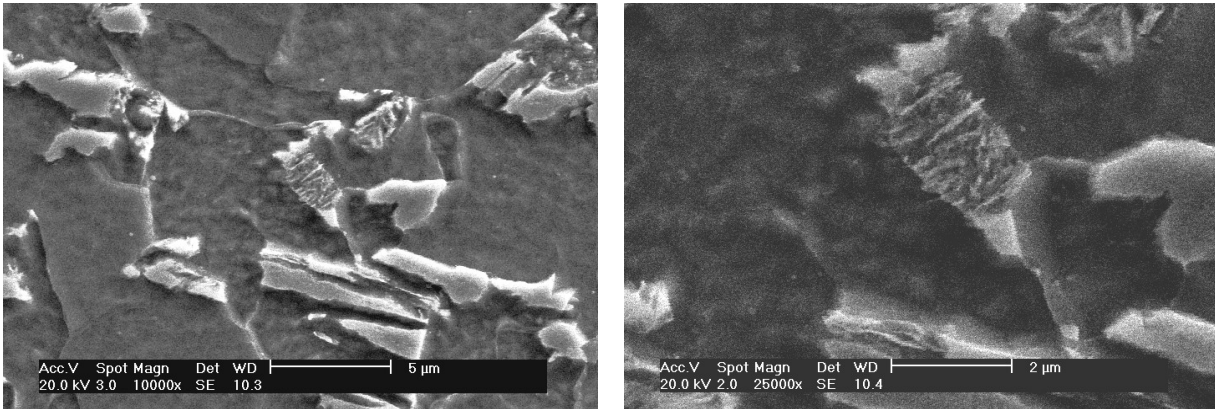
Figura 5- Microestrutura para taxa de 10°C/s. a) perlita degenerada, agregados eutetóides compactos e ferrita. b) perlita degenerada no detalhe.
