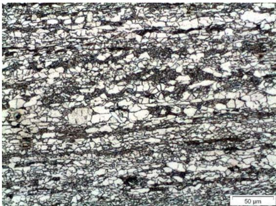
(a) Micrografia Centro da chapa. Nota-se  $\alpha_p$  em bandas de tamanho homogêneo, separados por bandas de bainita. 200X
