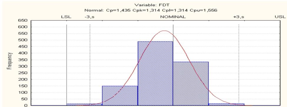
**Figura 6.** Capacidade do processo em termos de temperatura de acabamento para aços IF processados no Laminador de Tiras a Quente.
