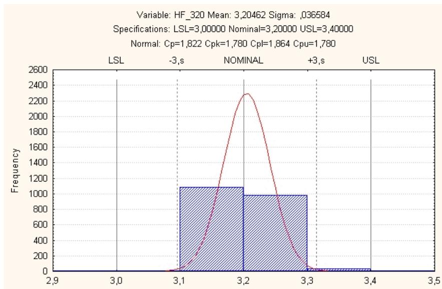
**Figura 4.** Capabilidade do processo em termos de espessura para bobinas a quente com valor desse parâmetro igual a 3,20 mm.
